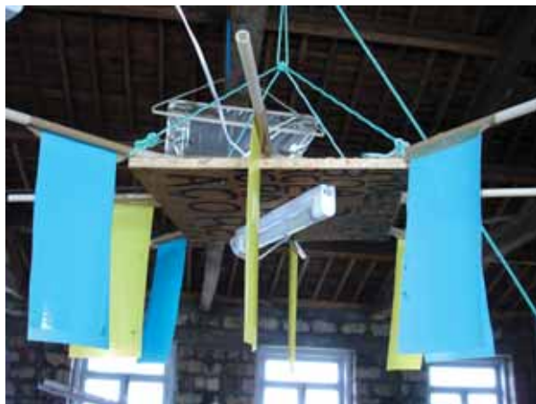
Figura 2 – Armadilha de luz fluorescente com papel autocolante azul e amarelo.
