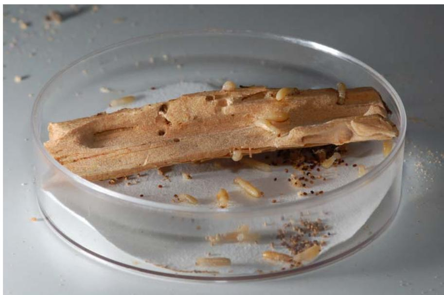
**Figura 1. Térmitas num bloco de *Cryptomeria japonica*.**
